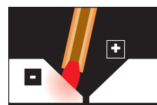
Vonkajšia vrstva je menej vodivá, výsledkom je pevný oblúk v dolnej časti úkosu zvárania.
